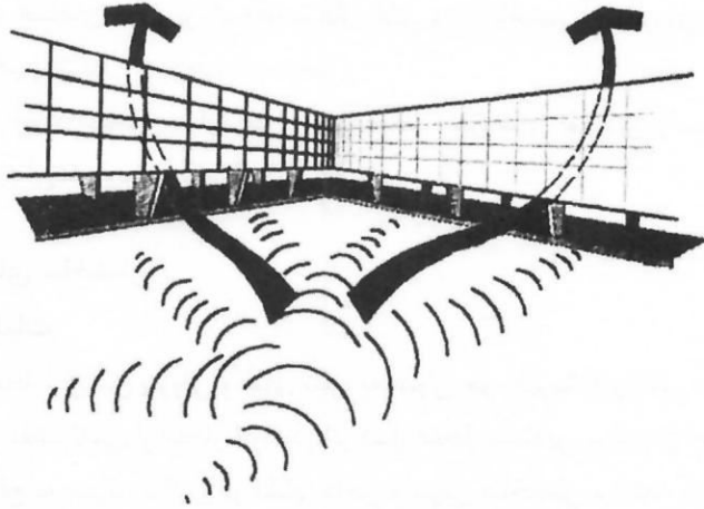
شکل ۲۱-۲-۵- تخلیه موج انفجار از پیلوت باز
