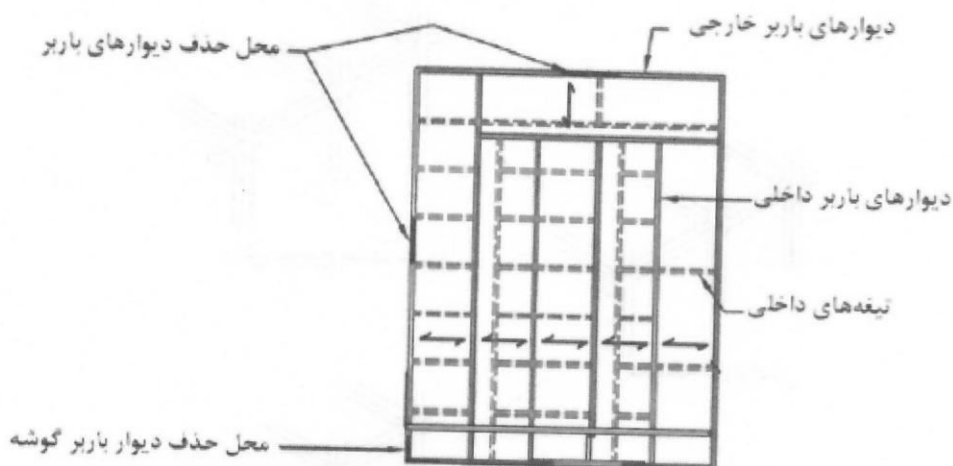
شکل ۲۱-۶-۶- موقعیت دیوارهای باربر خارجی که برای تحلیل انهدام پیش‌رونده باید حذف شوند.
